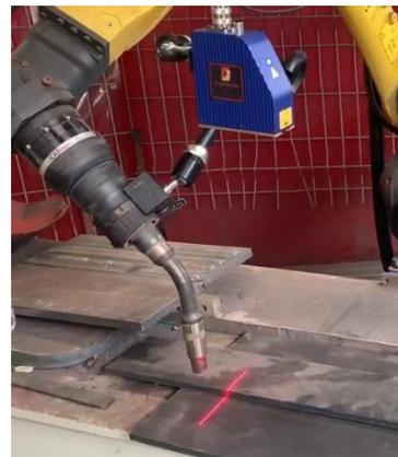
Vor dem Schweißen führt der Sensor 2 oder 3 Messungen an der Schweißnaht am Werkstück durch, um Position und Richtung zu bestimmen. Das Korrektursignal wird an die Robotersteuerung gesendet, und der Roboter führt eine Korrektur der ursprünglichen Programmierung durch und positioniert den Schweißbrenner an den Startpunkt der Schweißnaht. Der Schweißprozess erfolgt dann gemäß dem Roboterprogramm.
